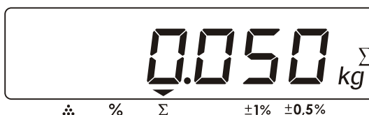
Рисунок 40. Показания дисплея при просмотре сумматора.
