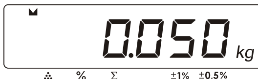
Рисунок 38. Показания дисплея при фиксированном весе.
