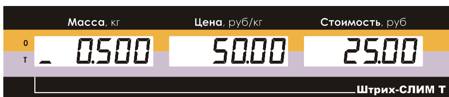
Рисунок 59. Показания дисплея после взвешивания товара в таре.
